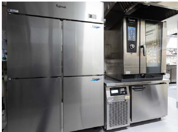
コンビオープンの下にはプラストチラーを設置しています。「料理をオープンから取り出してそのまま急速冷却に移れます」(高山シェフ)
