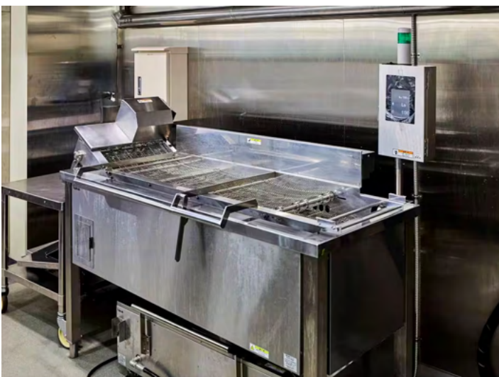
電気式の連続フライヤー。右側から投入された食材は、コンベアで左側に運ばれます(左写真)。コンビオーブンは2台に増設なさいました(右写真)
