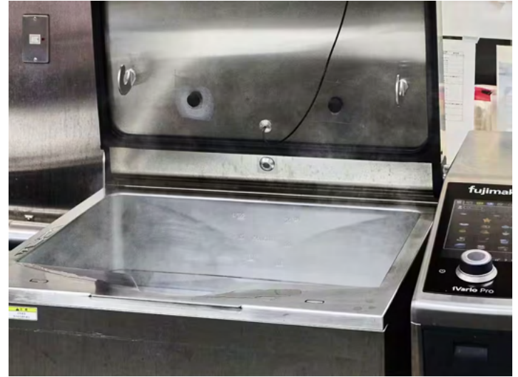
ガス式の自動炊飯器が並ぶ調理・配膳エリアの床はドライ仕様です（左写真）。 ブレイジングパンに代えて、100 リットルのバリオ大容量パンも採用いただきました（右写真）
