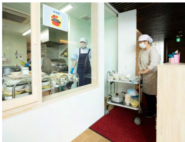
給食室のガラス窓手前の配膳エリアのみ廊下側と同じ高さになっており、盛り付けしたワゴンを折れ戸の扉から搬出することができます
