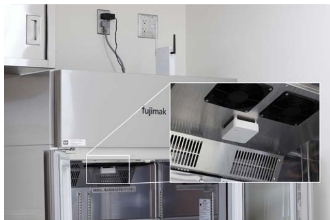
SHIMA の冷凍冷蔵庫に設置したキッチンリンク・クラウドのセンサー（囲み写真）と、通信用の親機（冷蔵庫上部）
