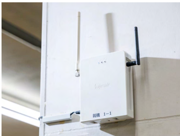
庫内温度を測定し、情報を親機に送る、キッチンリンク・クラウドの子機（左）と、親機（右）
